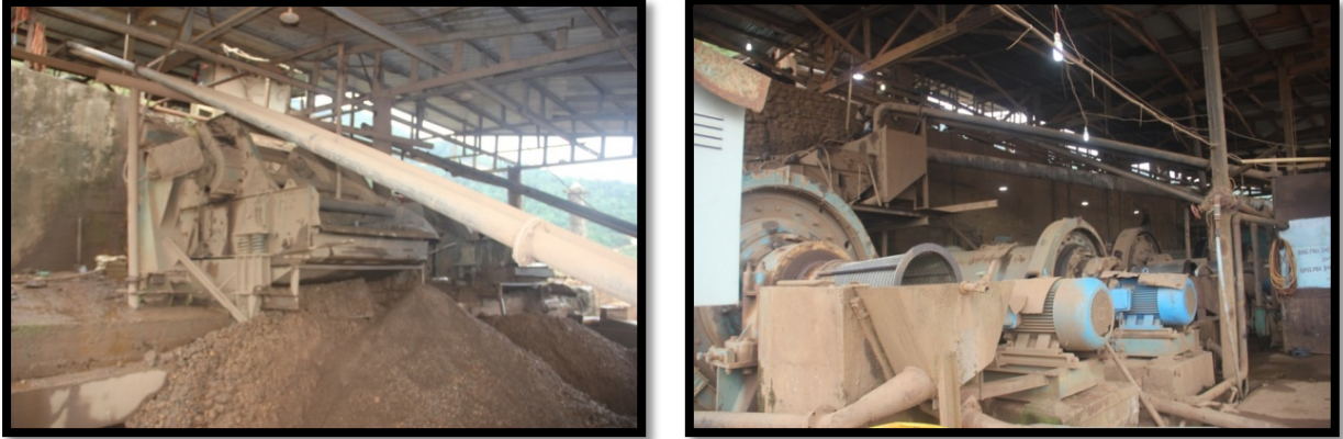
Figure 3.10 ဇကာအဆင့်ဆင့်ရွေးချယ်ခြင်း - သတ္တုခွဲခြားရေးတွင် အဆင့်နှစ်ဆင့်ပါ တုန်ခါစက်ကို အသုံးပြုပါသည်။ မြေနှင့်သတ္တုရောနေသည့် ဝမီလီမီတာထက်သေးငယ်သော အရည်ပျစ်များကို ဆေးကြော၍ တုန်ခါမှုအဆင့်ဆင့်ဖြင့် လှုပ်ခါနေသော စားပွဲကိုသုံး၍ သတ္တုအရည်အနည်ကို ရစေပါသည်။ သတ္တုအရည်အနည်ရစေရန် ဓာတုပစ္စည်းများ အသုံးမပြုပါ။
