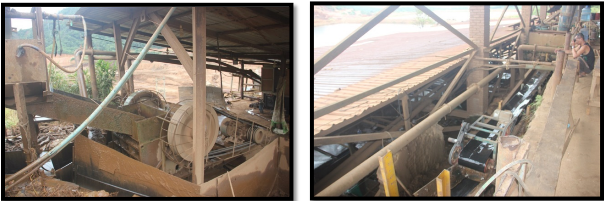
Figure 3.8 အရွယ်အစားခွဲခြားခြင်း- ဆေးကြောပြီးအရာများကို အရွယ်အစားခွဲခြားရန်အတွက် ထုလုံးရှည် ကျောက်ခွဲစက်သို့ပို့ပါသည်။ အရွယ်အစားကြီးသောထုလုံးရှည် ကျောက်ခွဲစက်၏အပေါ်ဆုံး အပိုင်းရှိ အရွယ်အစားခွဲစက်သည် တွင်းထွက်မြေစာများကို အရွယ်အမျိုးမျိုးခွဲခြားပေးပြီးအောက်ရှိ အရွယ်အစားခွဲ စားပွဲပေါ်သို့ပို့ပေးပုံ။
