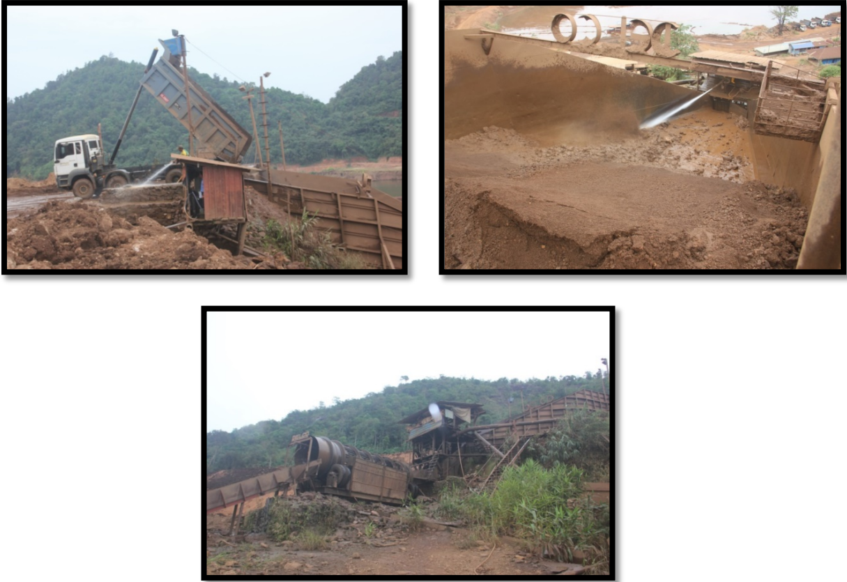
Figure 3.7 သတ္တုဆေးကြောသည့်နေရာသို့ပို့ဆောင်ခြင်း - ပထမဆုံးအဆင့်အနေဖြင့်သတ္တုရိုင်းများကို ဆေးကြောသည့်နေရာသို့ ပို့ဆောင်ပြီး ရေပန်းများဖြင့် ဆေးကြောပုံ။
