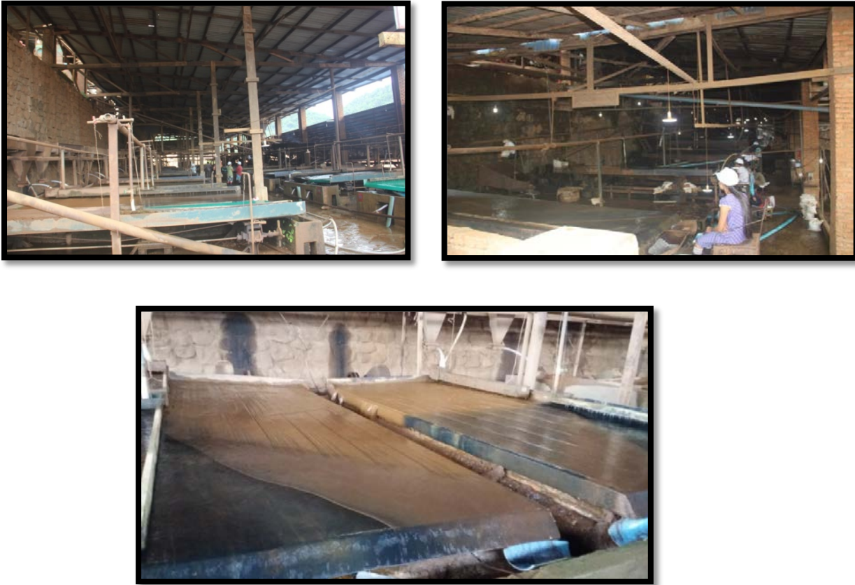
Figure 3.10 ဇကာအဆင့်ဆင့်ရွေးချယ်ခြင်း - သတ္တုခွဲခြားရေးတွင် အဆင့်နှစ်ဆင့်ပါ တုန်ခါစက်ကို အသုံးပြုပါသည်။ မြေနှင့်သတ္တုရောနေသည့် ဝမီလီမီတာထက်သေးငယ်သော အရည်ပျစ်များကို ဆေးကြော၍ တုန်ခါမှုအဆင့်ဆင့်ဖြင့် လှုပ်ခါနေသော စားပွဲကိုသုံး၍ သတ္တုအရည်အနည်ကို ရစေပါသည်။ သတ္တုအရည်အနည်ရစေရန် ဓာတုပစ္စည်းများ အသုံးမပြုပါ။
