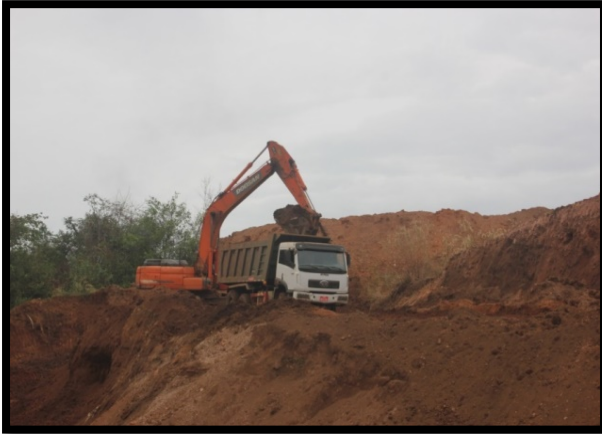
Figure 3.5 မြေစာများသယ်ဆောင်ခြင်း - အဖြိုက်နက်နှင့် သံဖြူရောနှောနေသော နန်းမြေများကို မြေသယ်ကားသို့ သယ်သွားပုံ အလေအလွင့်များ မဖြစ်စေရန် လေ့ခါးထပ်ပုံစံ ခုံတန်းရှည်များကို မြေတူးစက်ဖြင့် ပြုလုပ် ထားပါသည်။ ခုံတန်းရှည်သည် ၆၀ ဒီဂရီစောင်း၍ အမြင့် ၁၀ မီတာခန့် ရှိပါသည်။
